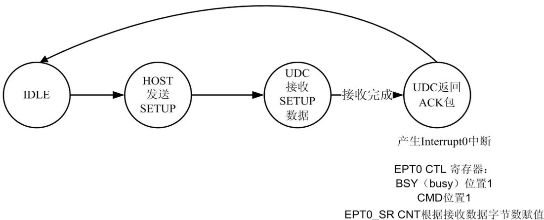
端点 0 接收和处理 SETUP 包，当 HOST 发送 SETUP 包时，端点 0 状态寄存器 BSY (busy) 位无论为何值，端点 0 都会正常接收 SETUP 包并产生中断。
