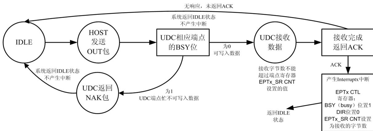
UDC 接收完数据后，如果没有返回 ACK，表示数据接收中产生异常，如 CRC 校验错误，DATA 的 PID 同步错误，或者接收数据超出寄存器 EPTx\_SR CNT 设置的值。此时系统将直接赶回 IDLE，不会产生 Interruptx 中断，会产生 Interrupt error 中断。
