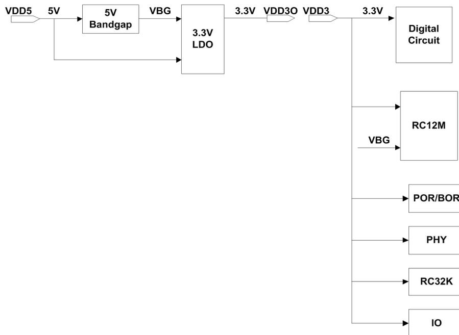
①5V 应用时，VDD5 输入 5V，3.3V 输出 VDD3O 和 3.3V 输入 VDD3 绑定在一起；
