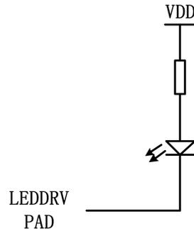
需要注意的是 P33~P35、P42~P44 两组端口同一时间只能开启一组端口的 LED 驱动功能（内置 LDO 驱动能力有限，对外驱动电流过大可能导致 LDO 输出电压不稳）。
